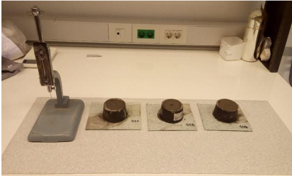
Slika 16. Određivanje početka i kraja vezanja Vicatovim aparatom
