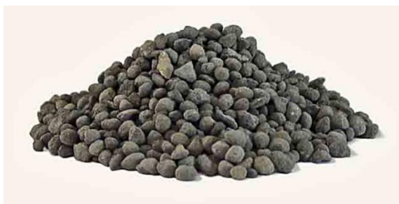
Slika 3. portland cementni klinker [4]
