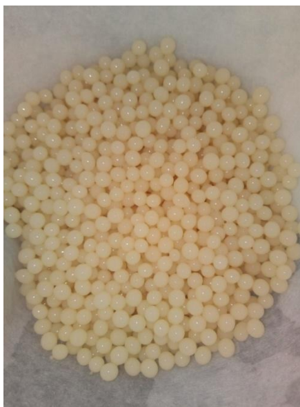
Slika 8. Kuglice nakon dekantacije, filtracije i ispiranja
