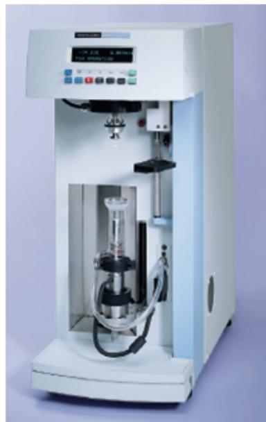
Slika 24. Aparatura za termogravimetrijsku analizu Pyris 1 TGA
