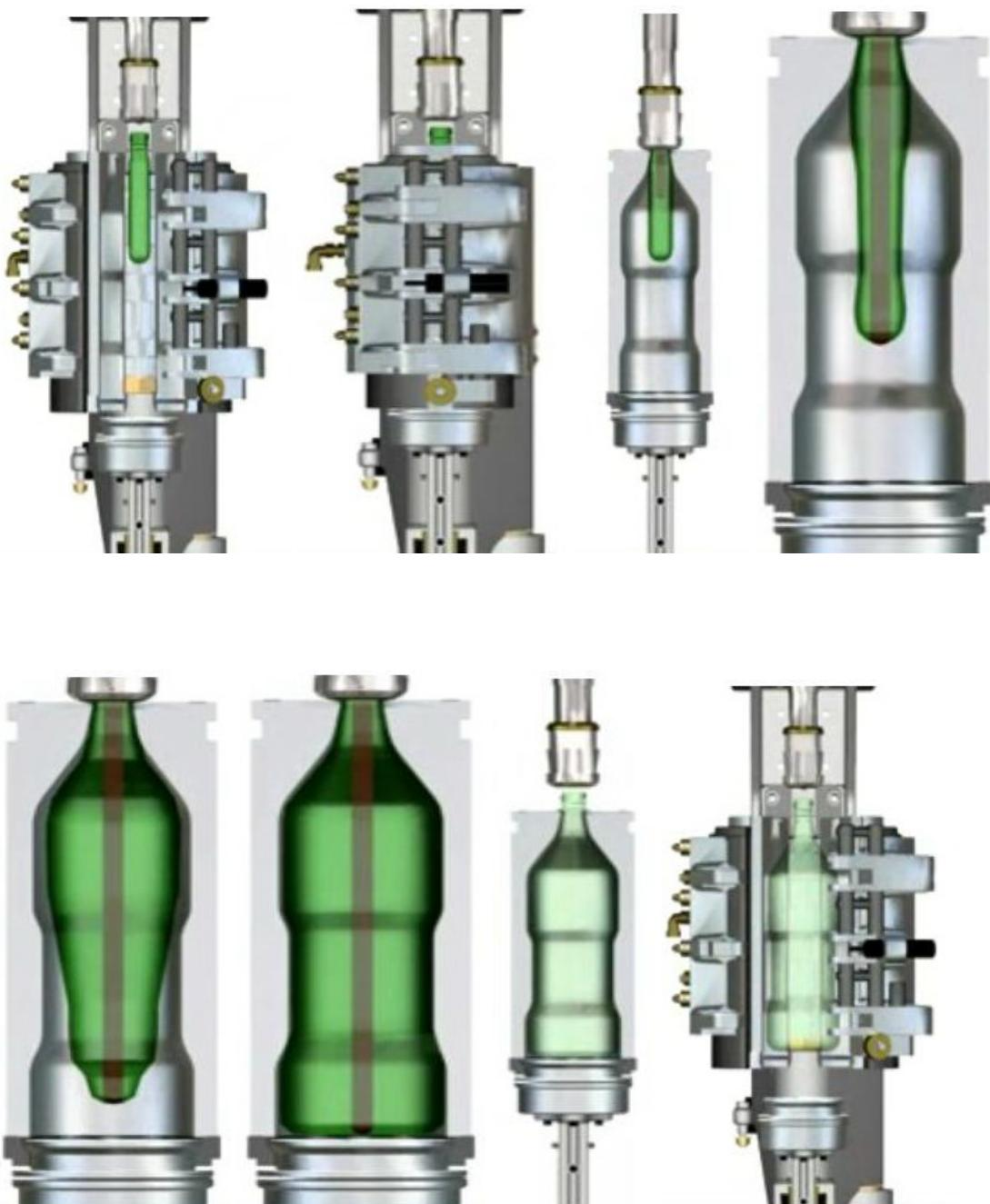
Slika 7. Postupna izrada boce u kalupu za puhanje od predoblika do gotovog proizvoda<sup>17</sup>
