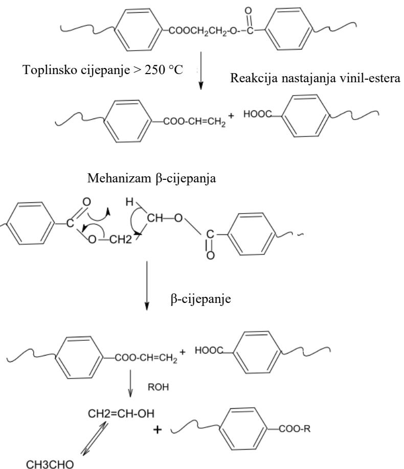
Slika 31. Temeljni proces cijepanja glavnog lanca PET-a<sup>50,55</sup>
