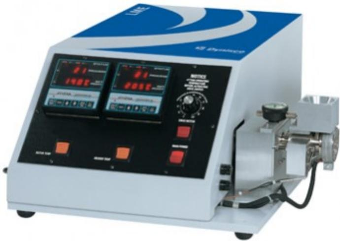
Slika 22. Jednopužni laboratorijski ekstruder Dynisco
