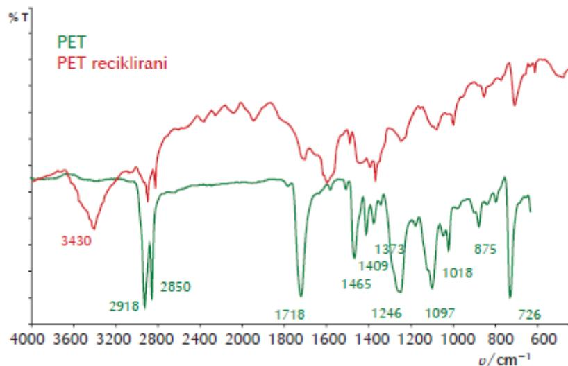
Slika 15. FTIR-spektar čistog polimera PET-a i PET-a nakon postupka recikliranja<sup>26</sup>
