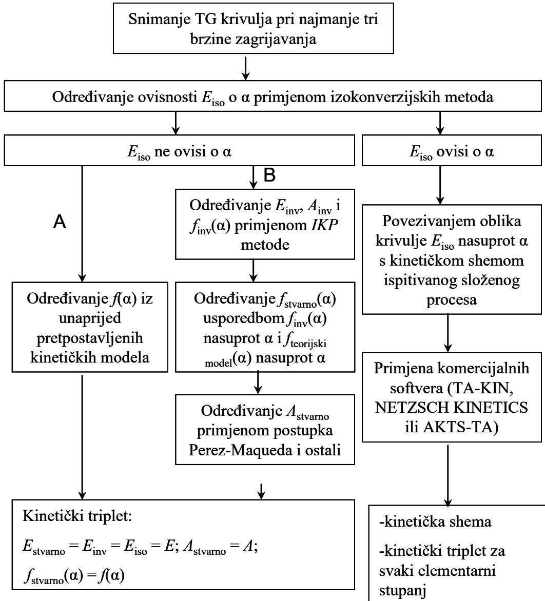
Slika 18. Opći algoritam za određivanje kinetičkih parametara iz dinamičkih TG podataka.<sup>38</sup>
