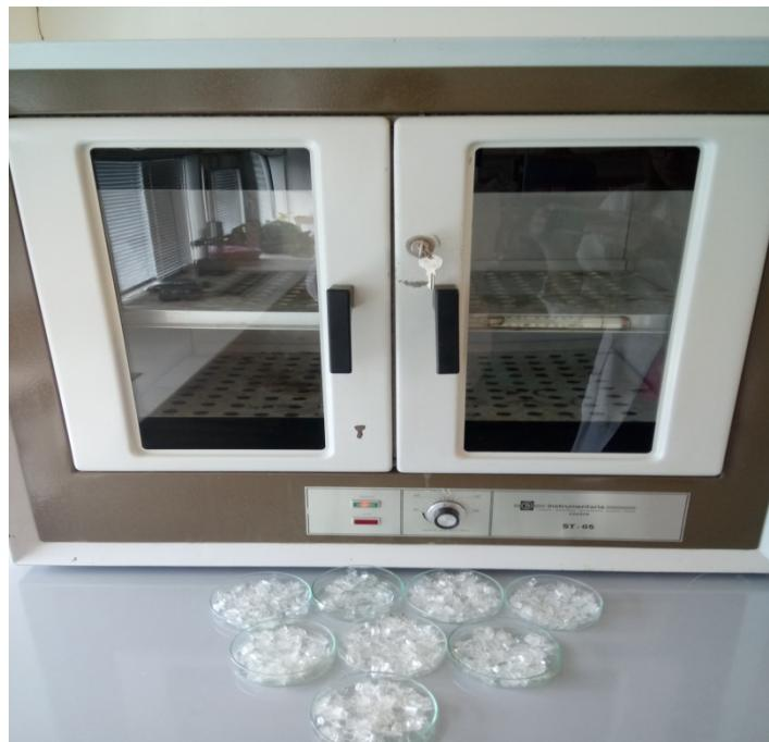
Slika 21. Sušionik Instrumetaria ST-05
