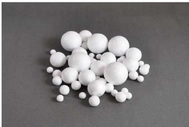
Slika 6. Kuglice pjenastog polistirena 10
