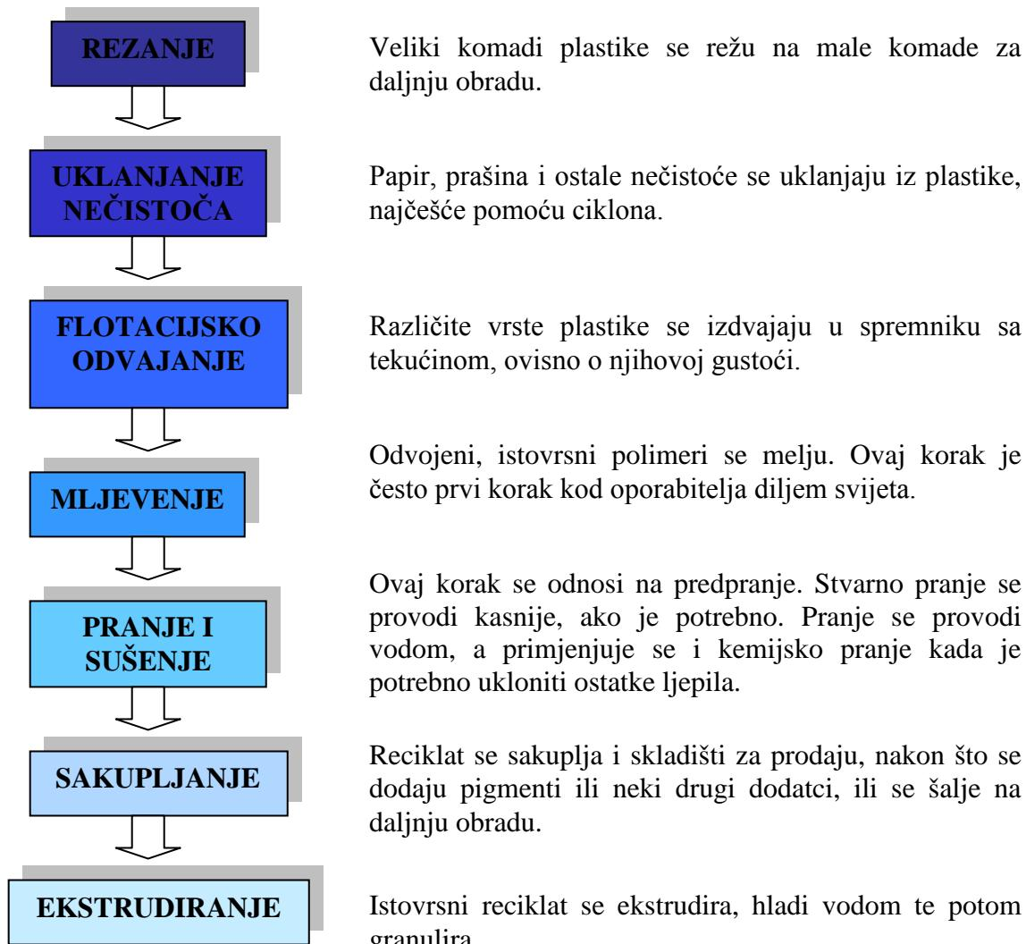
Slika 28. Shema mehaničkog recikliranja plastičnog otpada<sup>36</sup>
