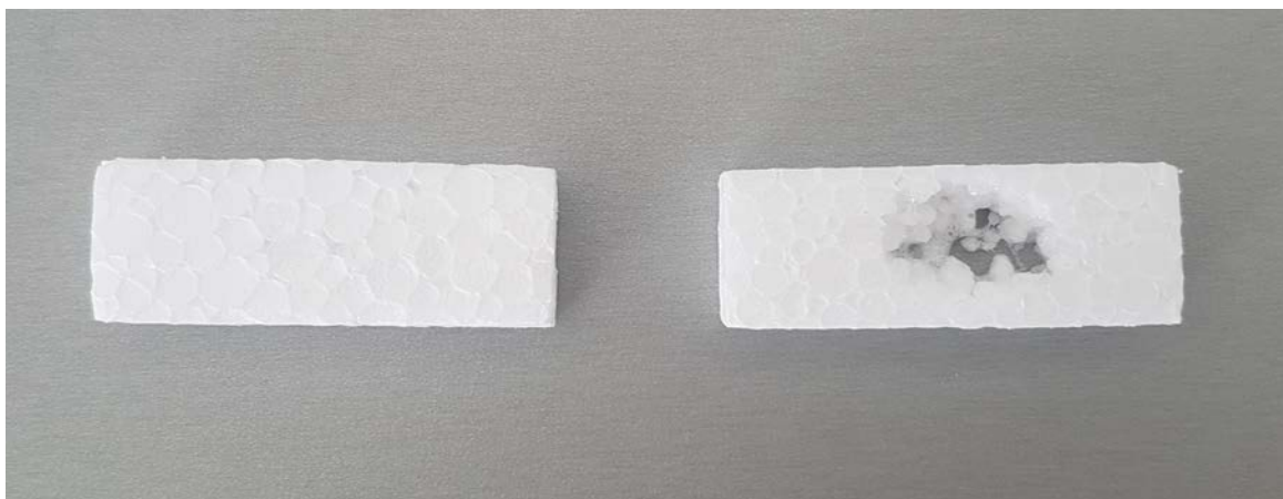
Slika 37. Netaknut uzorak PS-E-a te uzorak koji je pokapan limonenom
