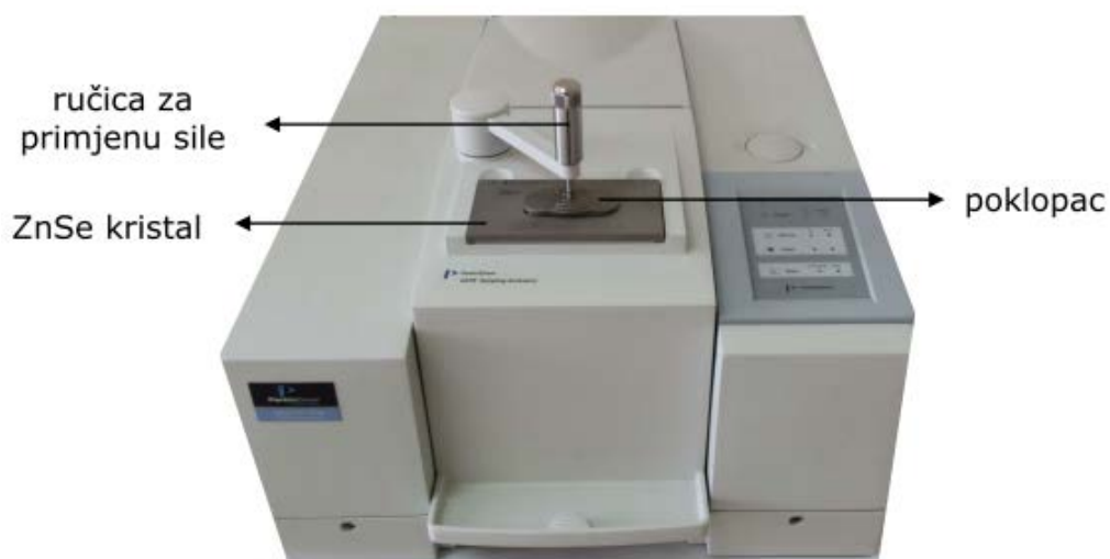
Slika 35. FT-IR spektrometar Spectrum One (Perkin-Elmer) s dodatkom za snimanje HATR tehnikom 4
