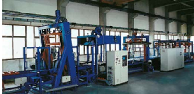
Slika 14. Stroj za rezanje stiropor blokova u ploče 14
