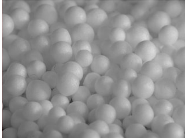
Slika 8. Predeksandirane granule polistirena 11
