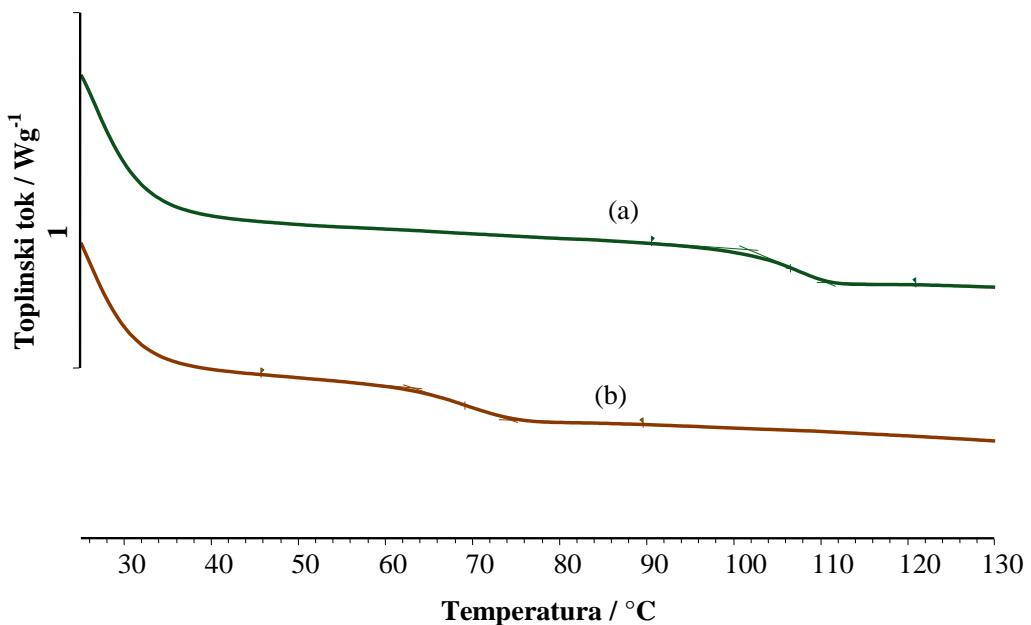
Slika 43. Normalizirane DSC krivulje drugog zagrijavanja PS-E-a (a) i PS-E<sup>p</sup>-a (b)
