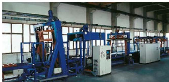
Slika 14. Stroj za rezanje stiropor blokova u ploče<sup>14</sup>
