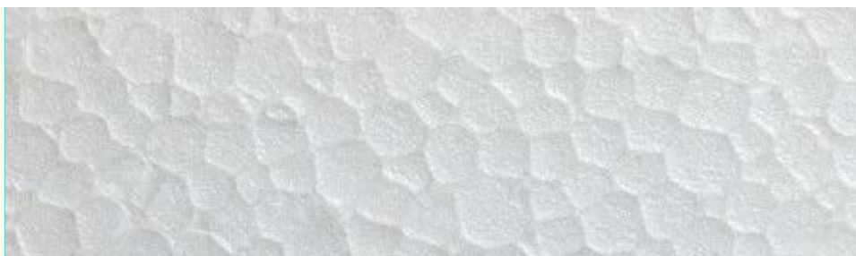
Slika 7. Struktura pjenastog polistirena 11
