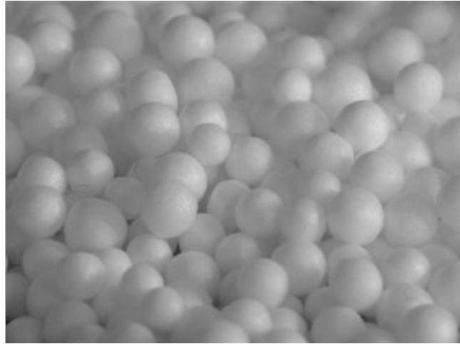
Slika 8. Predeksandirane granule polistirena 11
