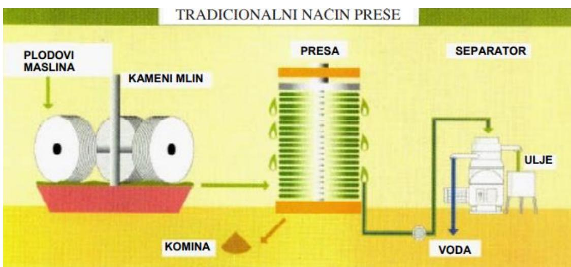
Slika 10. Shematski prikaz proizvodnje maslinova ulja tradicionalnim nacinom preše.<sup>25</sup>
