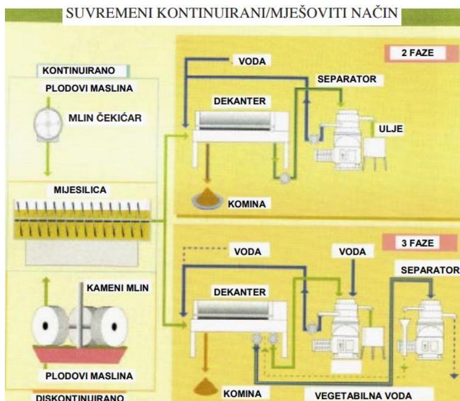
Slika 11. Shematski prikaz proizvodnje maslinova ulja u dvofaznom i trofaznom sustavu.<sup>25</sup>
