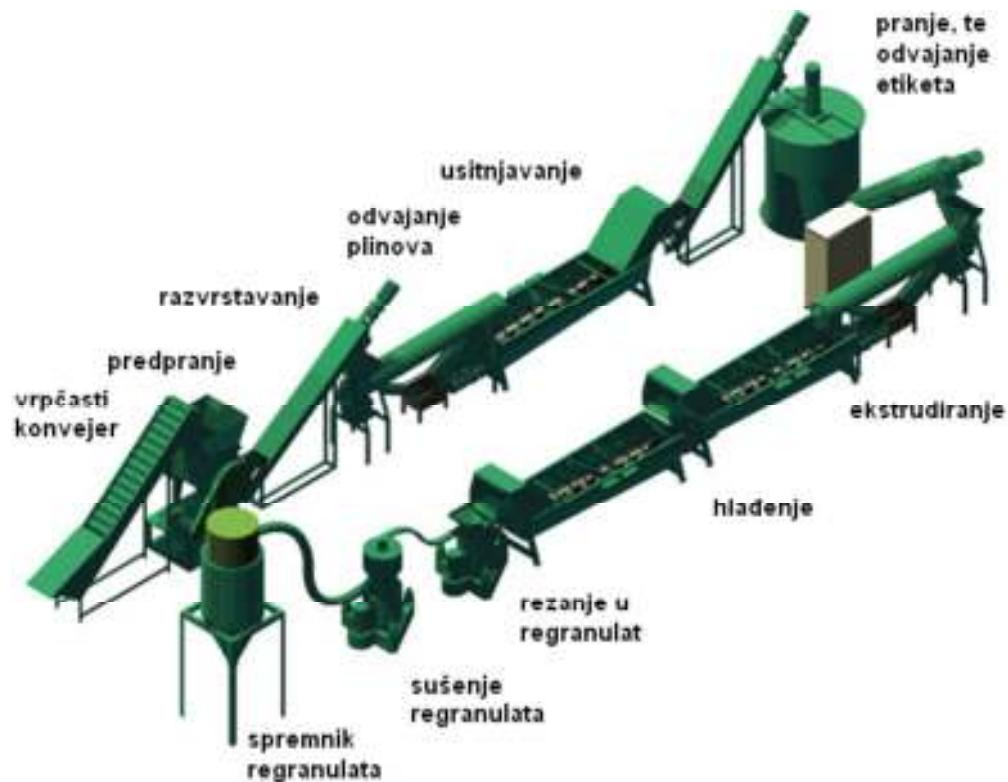
Slika 20. Prikaz linije za recikliranje PET boca postupkom *od boce do boce*<sup>30</sup>
