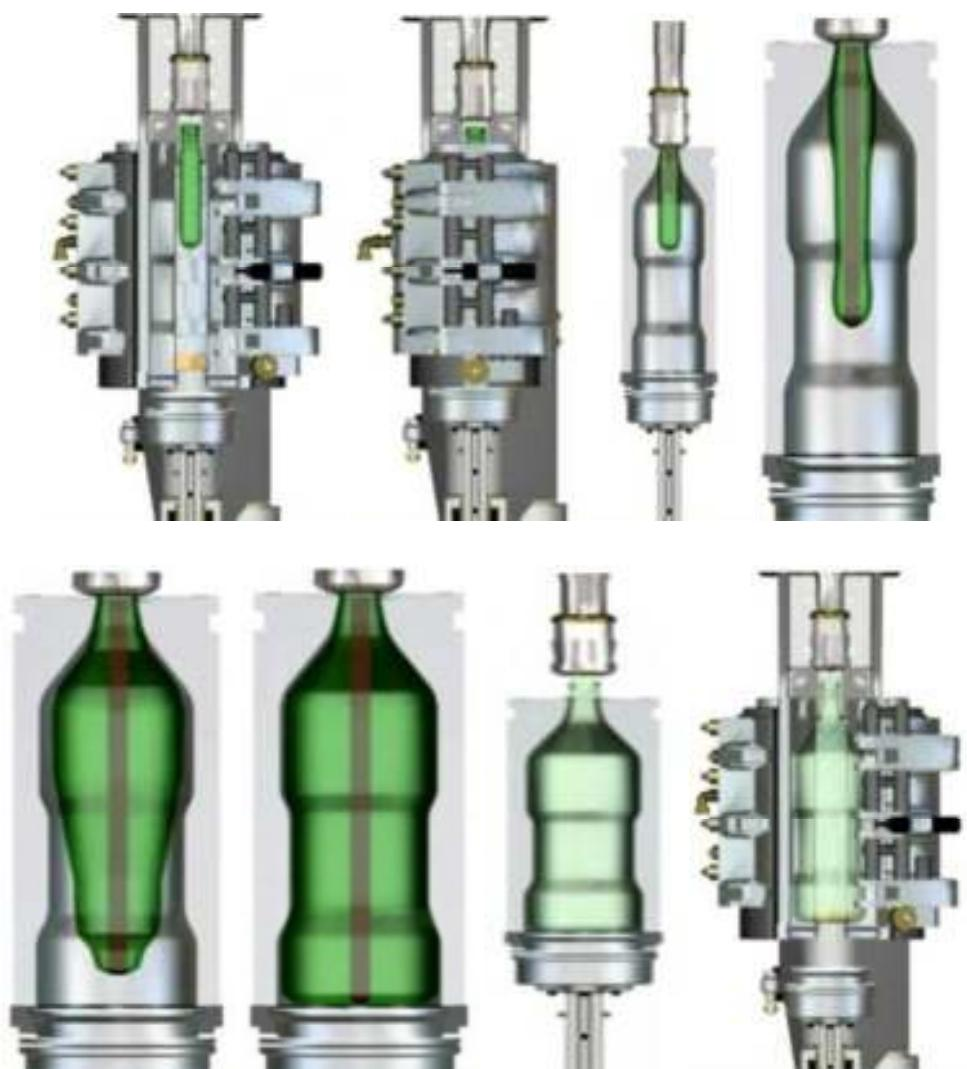
Slika 6. Postupna izrada boce u kalupu za puhanje od predoblika do gotovog proizvoda<sup>16</sup>
