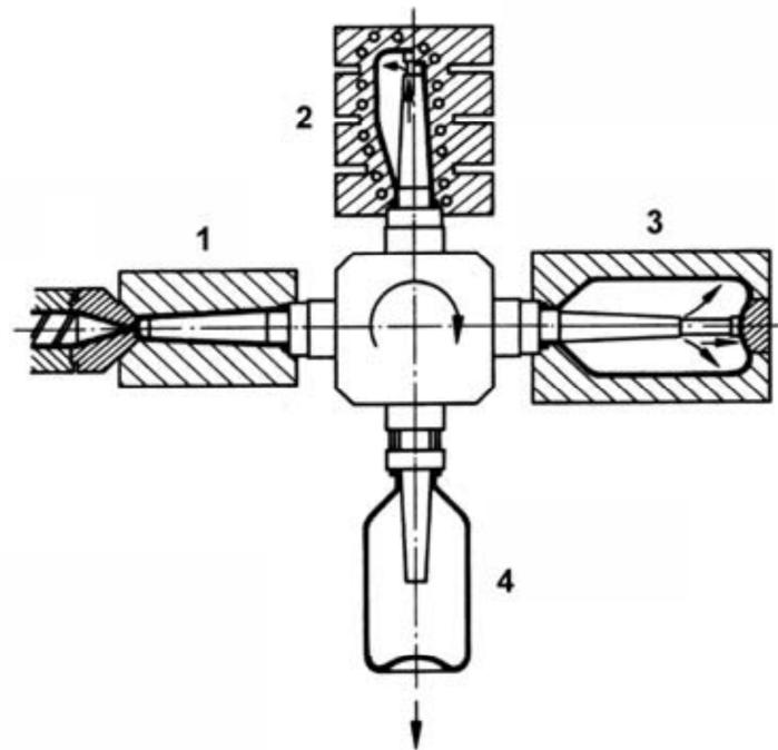
Slika 9. Postupak jednofaznog injekcijskoga razvlačnog puhanja, 1 – injekcijsko prešanje predoblik, 2 – kondicioniranje odnosno pretpuhanje, 3 – razvlačenje i puhanje, 4 – izbacivanje gotovih proizvoda<sup>20</sup>
