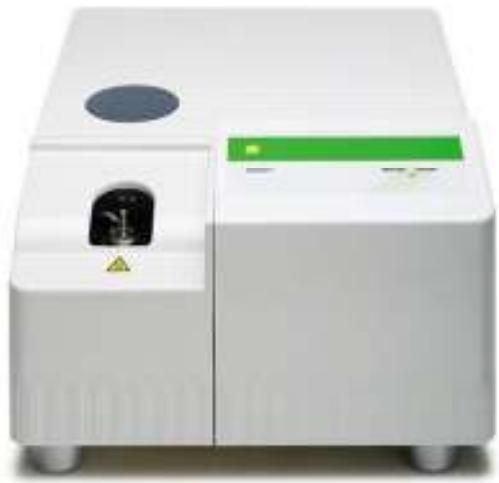
Slika 30. Diferencijalni pretražni kalorimetar DSC823<sup>e</sup> (Mettler Toledo)
