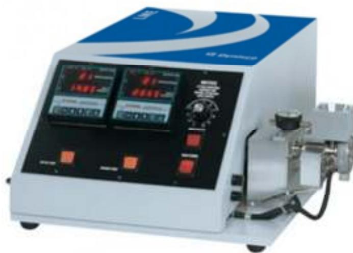
Slika 27. Jednopužni laboratorijski ekstruder Dynisco
