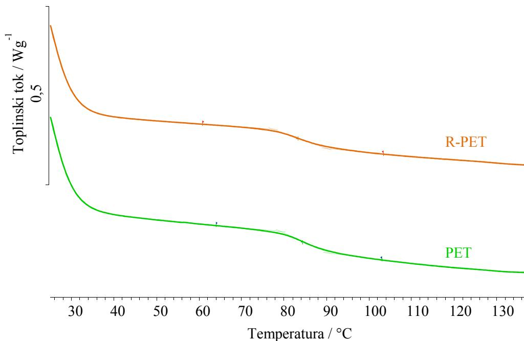
Slika 33. Normalizirane DSC krivulje zagrijavanja istraživanih uzoraka (u području staklastog prijelaza)
