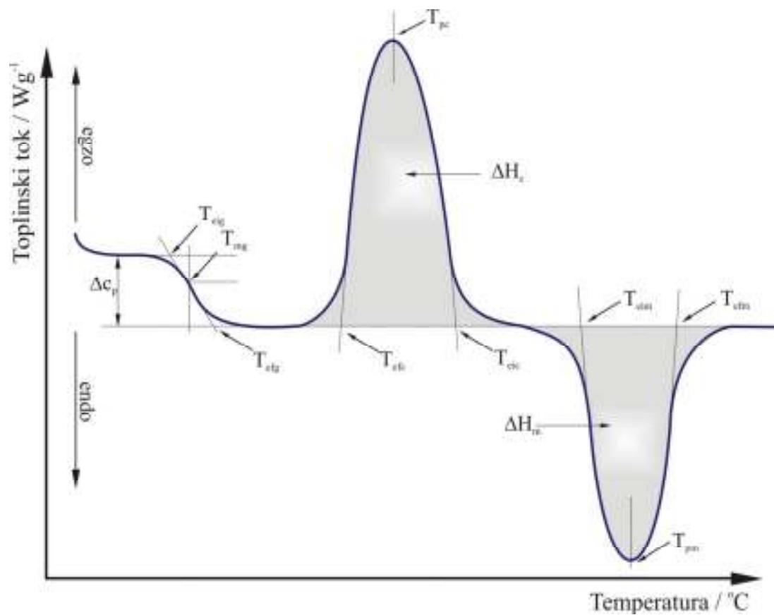
Slika 23. Prikaz i određivanje značajki krivulje diferencijalne pretražne kalorimetrije<sup>39</sup>
