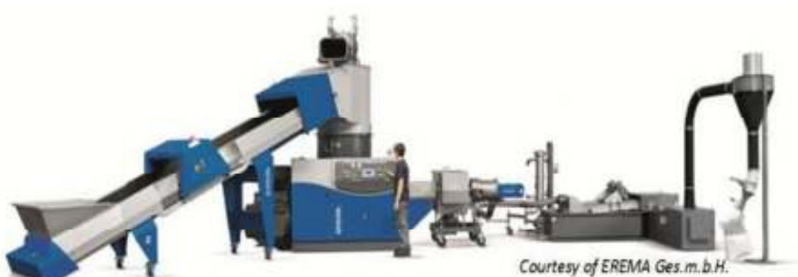
Slika 16. Uređaj za mehaničko recikliranje<sup>27</sup>
