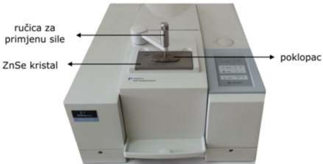
Slika 29. FT-IR spektrometar Spectrum One (Perkin–Elmer) s dodatkom za snimanje HATR tehnikom<sup>38</sup>
