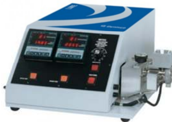
Slika 27. Jednopužni laboratorijski ekstruder Dynisco
