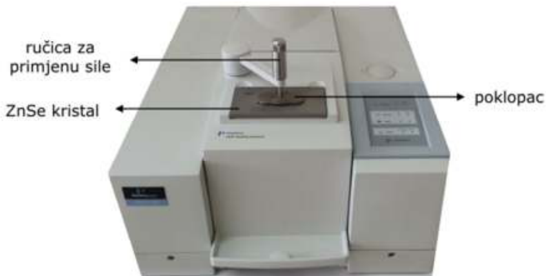
Slika 29. FT-IR spektrometar Spectrum One (Perkin–Elmer) s dodatkom za snimanje HATR tehnikom 38
