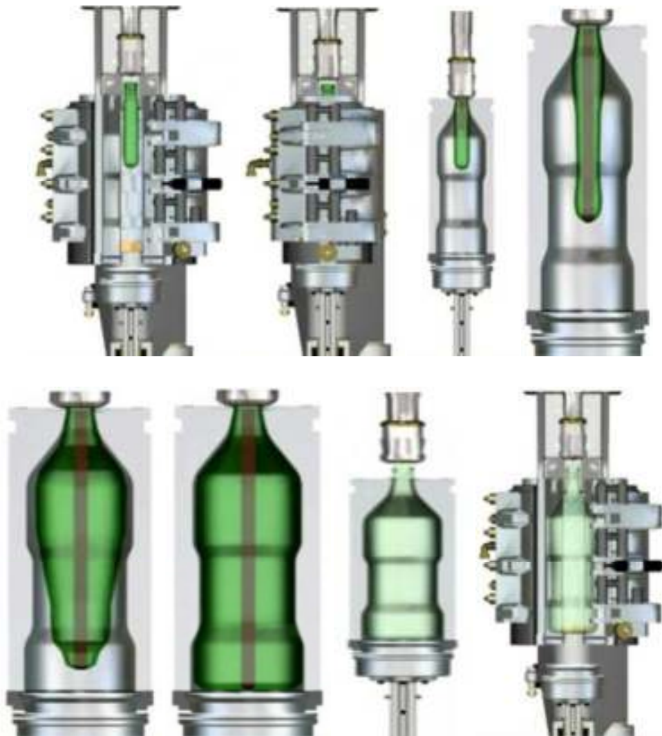
Slika 6. Postupna izrada boce u kalupu za puhanje od predoblika do gotovog proizvoda 16
