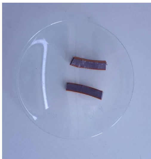
Slika 12. Uzorak 6 (PVC materijal nepoznatog sadržaja punila)
