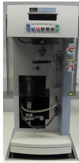
Slika 14. Aparatura za termogravimetrijsku analizu Pyris 1 TGA (Perkin-Elmer)
