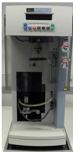
Slika 14. Aparatura za termogravimetrijsku analizu Pyris 1 TGA (Perkin-Elmer)
