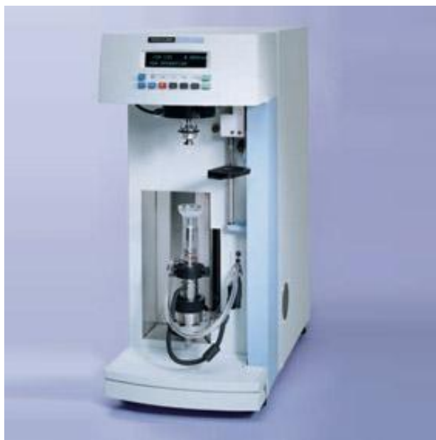
Slika 23. Aparatura za termogravimetrijsku analizu, Pyris 1 TGA
