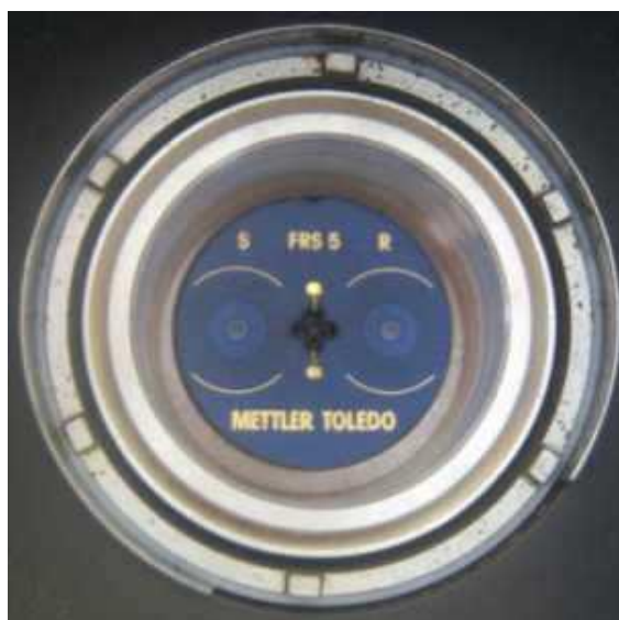
Slika 22. Mjerno osjetilo (FRS 5) DSC uređaja
