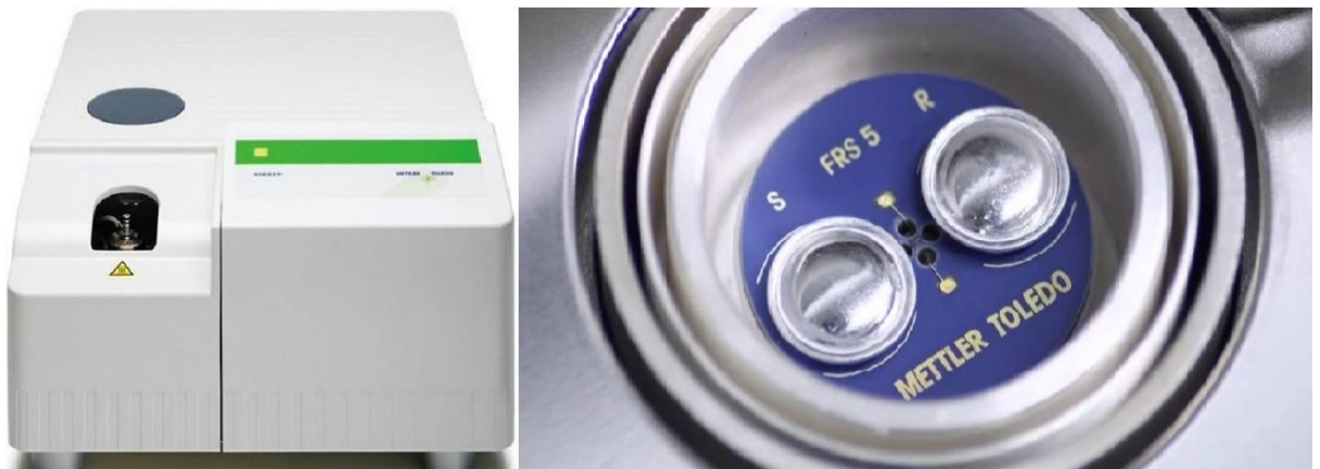
Slika 16. DSC 823 e Mettler Toledo kalorimetar i pripadajuće mjerno osjetilo
