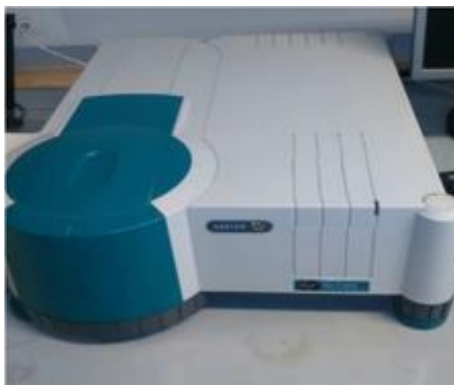
Slika 16. Određivanje lakopristupačnog fosfora AL-metodom
