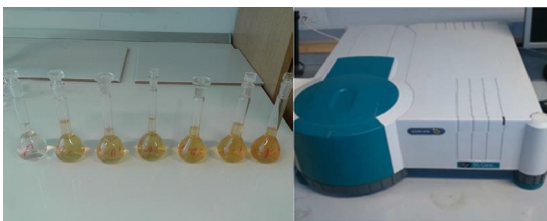
Slika 15. Određivanje amonijačnog dušika u tlu
