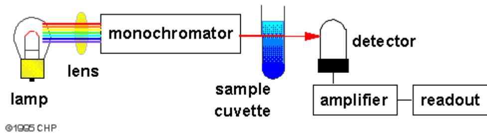
Slika 3. Shematski prikaz dijelova spektrofotometar<sup>14</sup>
