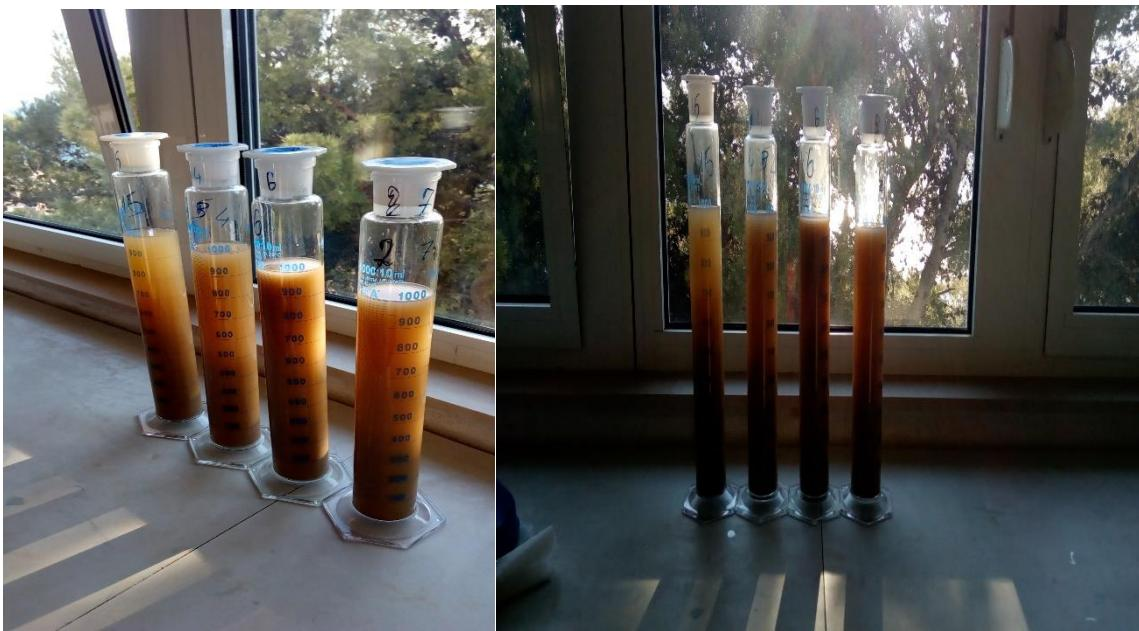
**Slika 13.** Cilindri za određivanje mehaničkog sastava tla
