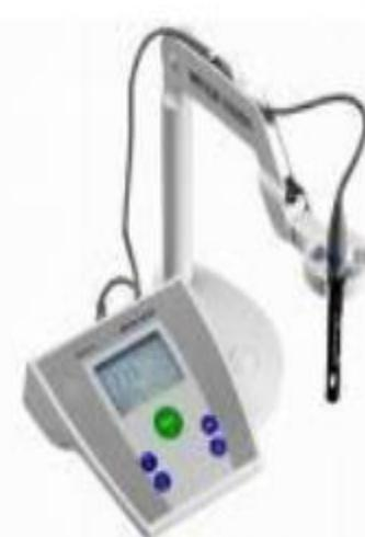
**Slika 11.** Mikroprocesorski laboratorijski pH – metar s kombiniranim staklenom elektrodom
