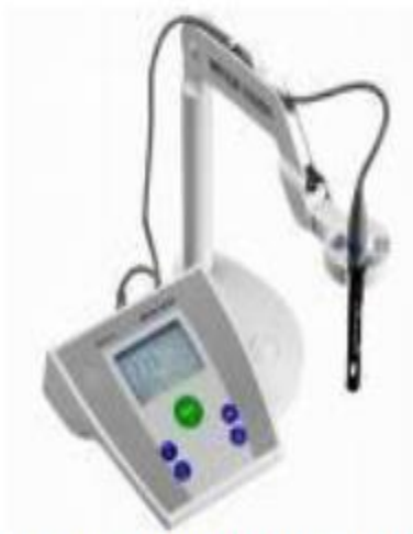
Slika 11. Mikroprocesorski laboratorijski pH – metar s kombiniranom staklenom elektrodom
