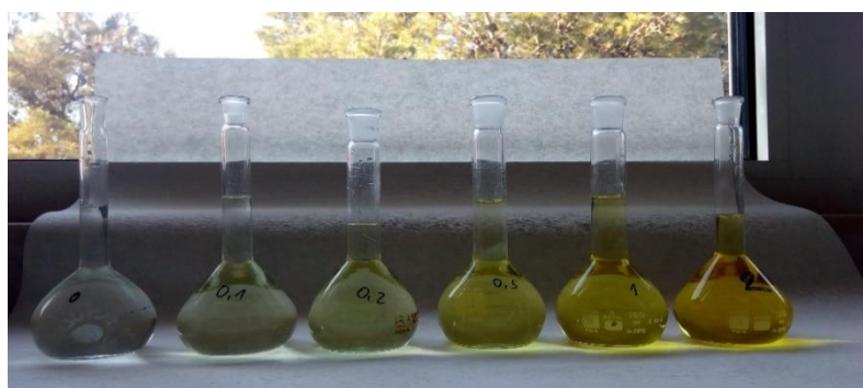
Slika 18. Standardi za metodu određivanja P u biljnom materialu
