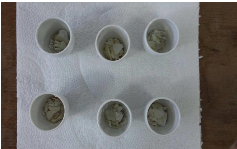
Slika 11. Prikaz osušenog filter papira u lončićima za žarenje
