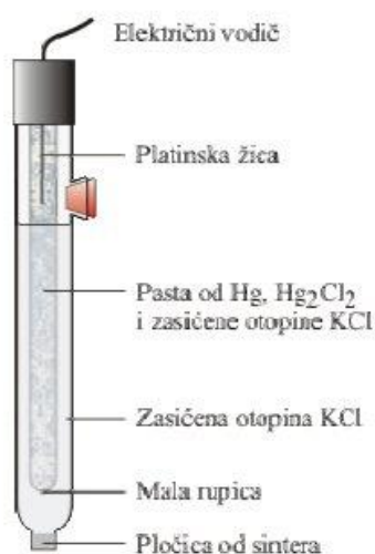
Slika 3. Shematski prikaz zasićene kalomel elektrode 3
