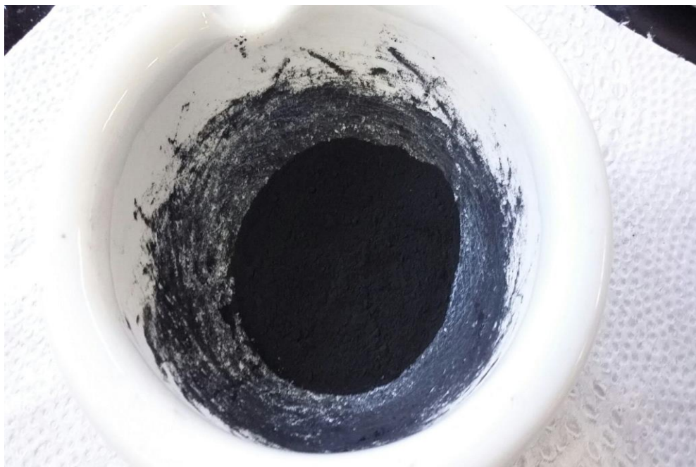
Slika 11. Izgled usitnjenog srebrovog sulfida u tarioniku
