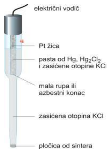
Slika 5. Prikaz kalomelove elektrode 3
