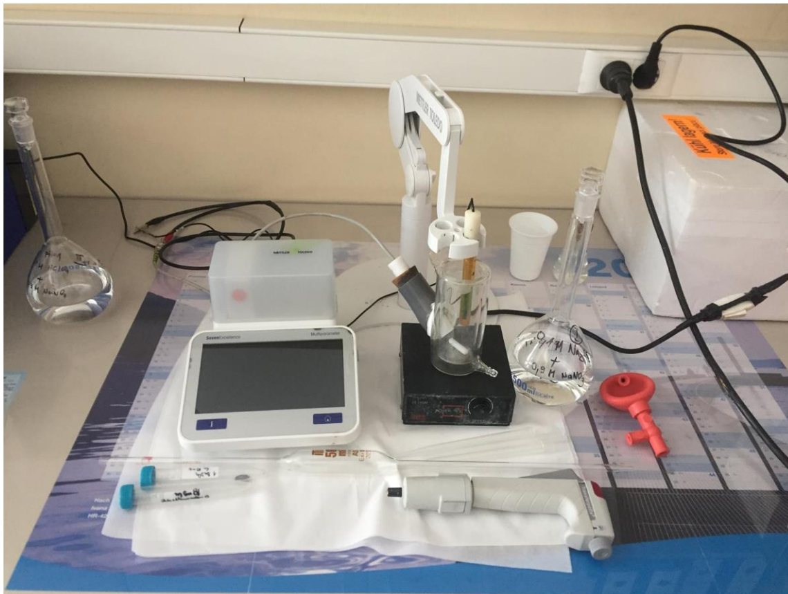
Slika 7. Aparatura za potenciometrijsko mjerenje
