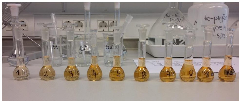
Slika 3-5 Pripravljene otopine za određivanje stehiometrije kompleksa metodom molarnih omjera
