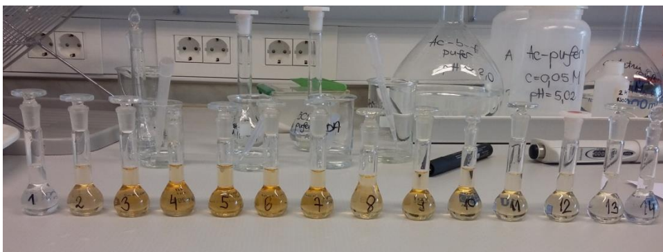
Slika 3-7 Pripravljene otopine za određivanje udio metala metodom kontinuirane varijacije
