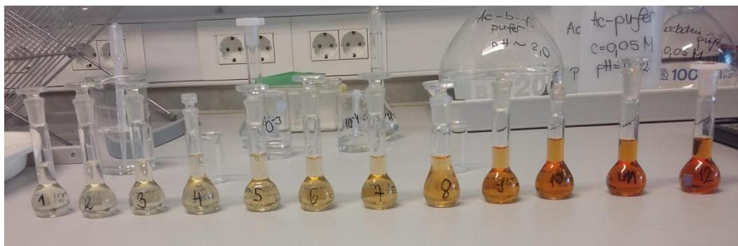
Slika 3-8 Pripravljene otopine za određivanje LDP-a bakra(I)
