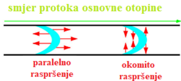
Slika 2-6 Okomito i paralelno raspršenje (i difuzija) – utjecaj na koncentracijski gradijent [12]
