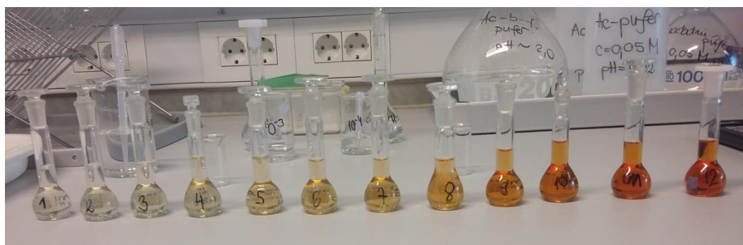
Slika 3-8 Pripravljene otopine za određivanje LDP-a bakra(I)
