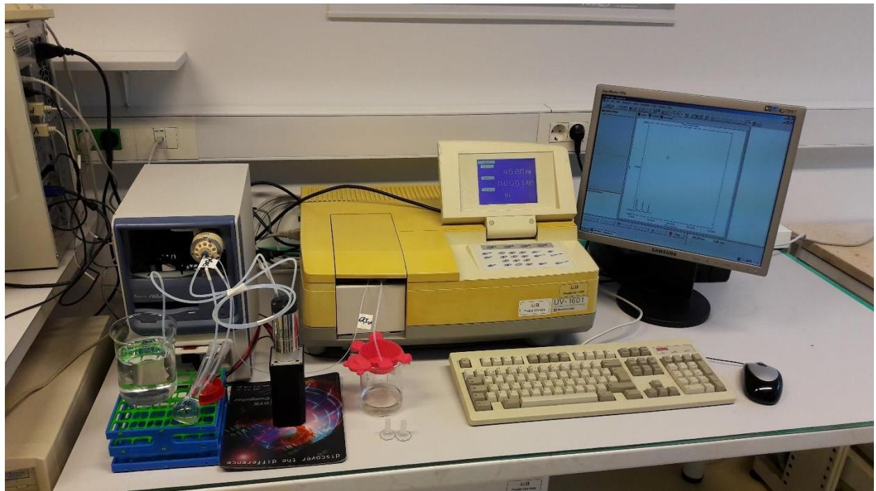
Slika 3-3 Instrumentacija za izvođenje slijedne analize injektiranjem uz spektrofotometrijski detektor
