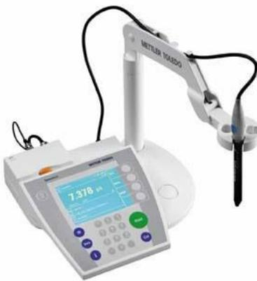
Slika 3-4 Milivoltmetar Mettler Toledo SevenMulti opremljen kombiniranim staklenom elektrodom.<sup>[22]</sup>
