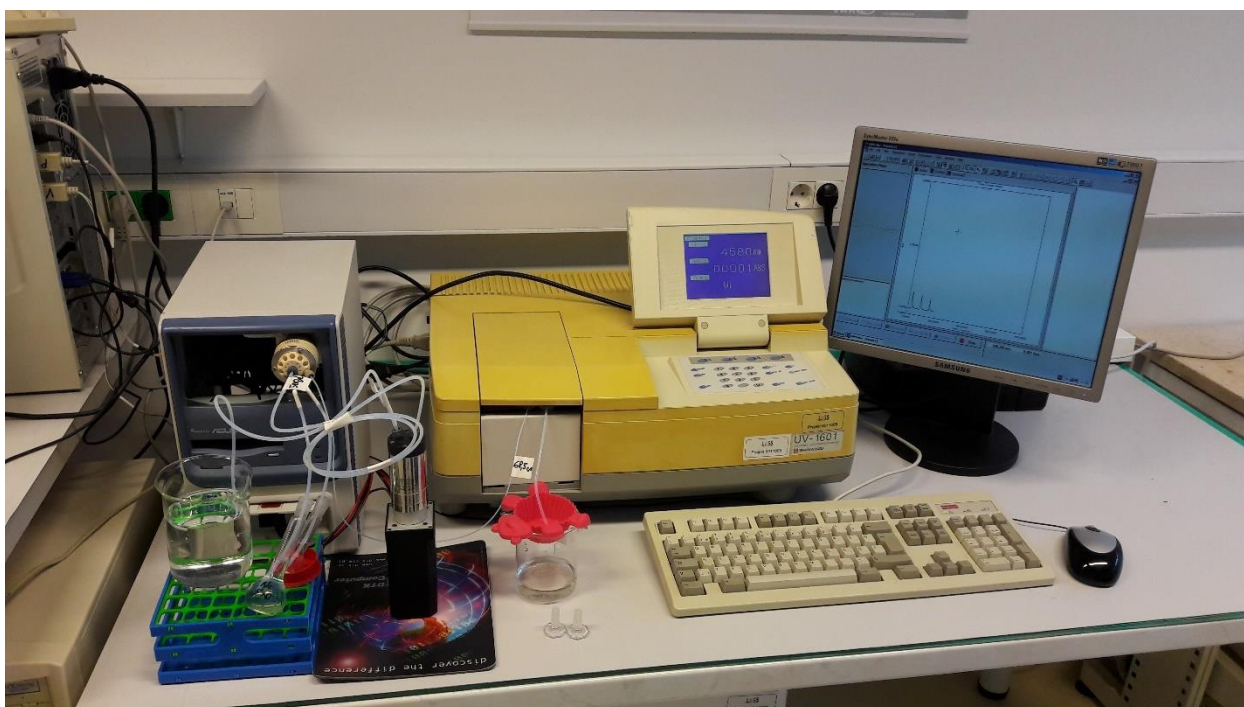
Slika 3-3 Instrumentacija za izvođenje slijedne analize injektiranjem uz spektrofotometrijski detektor
