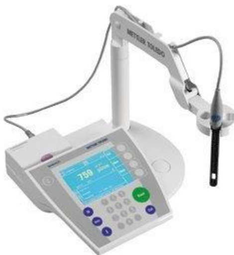
Slika 3.8. Milivoltmetar Mettler Toledo SevenMulti (Mettler Toledo, Schwerzenbach, Švicarska) opremljenim staklenom elektrodom, Mettler Toledo InLab®
