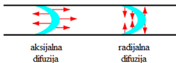
Slika 3.4. Prikaz aksijalne difuzije, koja uzrokuje laminarno gibanje, i radijalne difuzije, koja uzrokuje turbulentno gibanje
