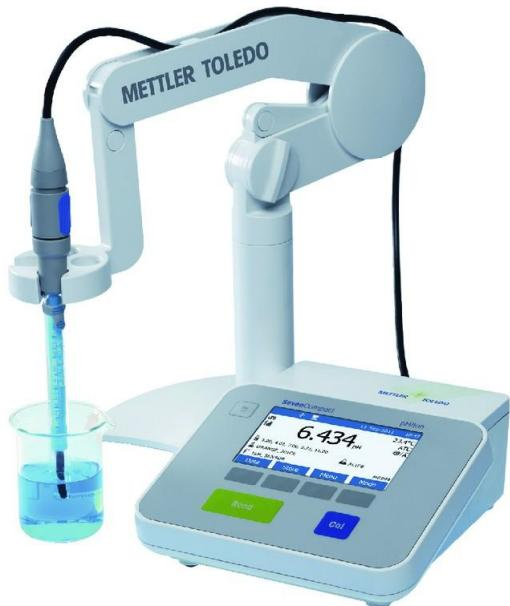
Slika 3.5. Milivoltmetar korišten za mjerjenje pH vrijednosti [20]
