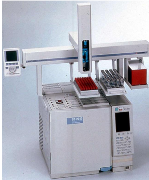
Slika 5. Plinski kromatograf s plameno-ionizacijskim detektorom; Shimadzu GC-2010 (46).
