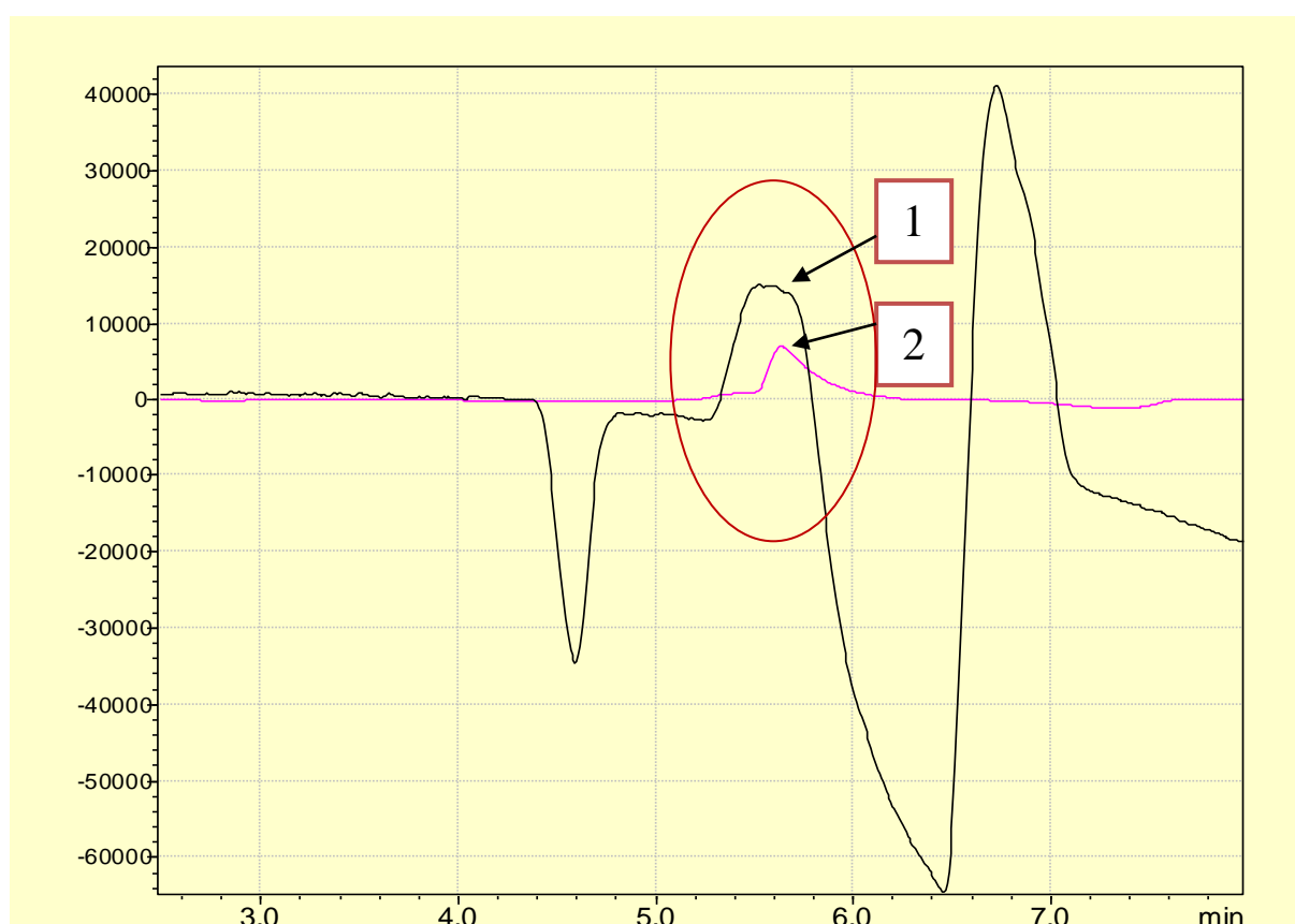
Slika 8. Usporedba rezultata dobivenih analizom standarda metadona koncentracije 1 mg/L upotrebom različitih mobilnih faza za HPLC analizu:
