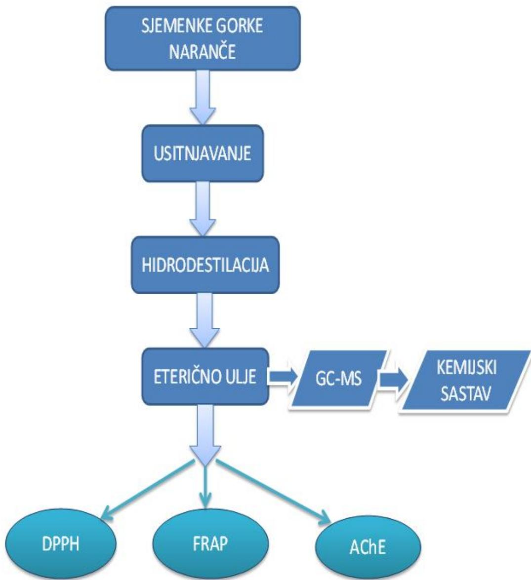
**Slika 19.** Shematski prikaz izolacije eteričnog ulja i primijenjenih metoda u radu
