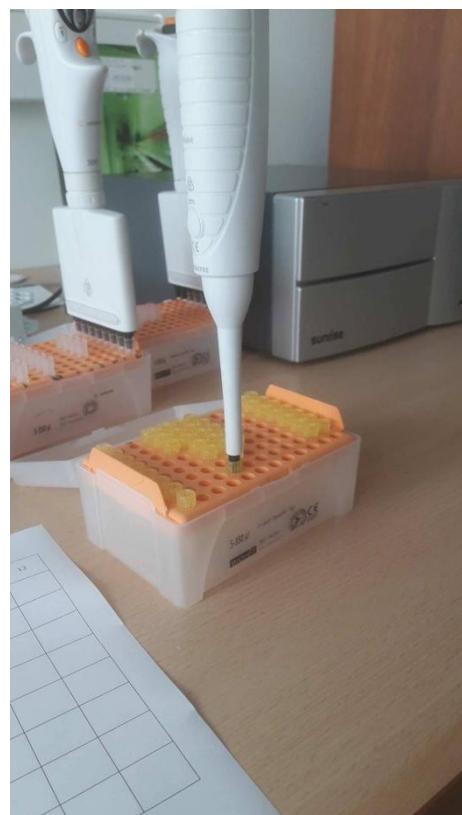
**Slika 23.** Mikropipete i višekanalni čitač mikrotitarskih pločica "Sunrise" (Tecan, GmbH, Austrija)
