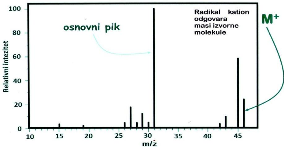
**Slika 14.** Spektar masa etanola ( $\text{CH}_3\text{CH}_2\text{OH}$ , molekulska masa,  $\text{Mr} = 46$ )
