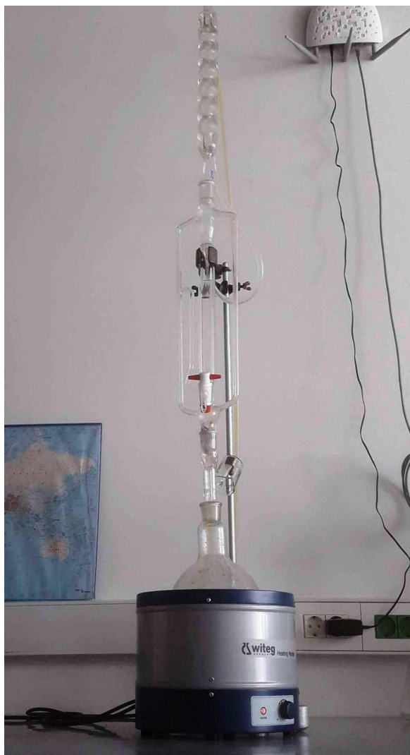
Slika 20. Izolacija eteričnog ulja vodenom destilacijom u aparaturi po Clevengeru
