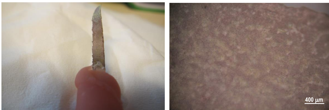
Slika 30. Snimke površine CuAlNi elektrode nakon polarizacijskih mjerenja u 0,1 % NaCl otopini, T = 37\text{ }^{\circ}\text{C} , \text{pH} = 7,4 : a) makro snimka i b) uvećanje 50 puta.
