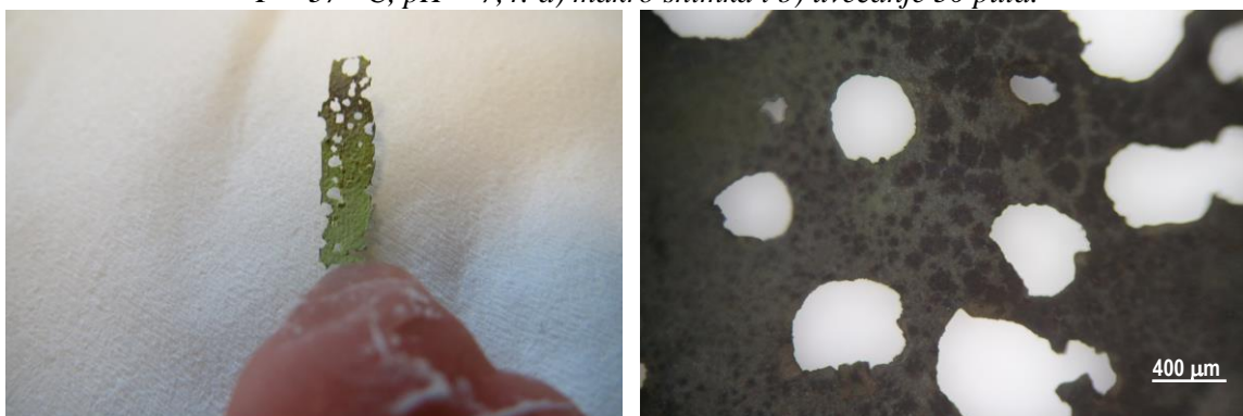
Slika 31. Snimke površine CuAlNi elektrode nakon polarizacijskih mjerenja u 1,5 % NaCl otopini, T = 37\text{ }^{\circ}\text{C} , \text{pH} = 7,4 : a) makro snimka i b) uvećanje 50 puta.
