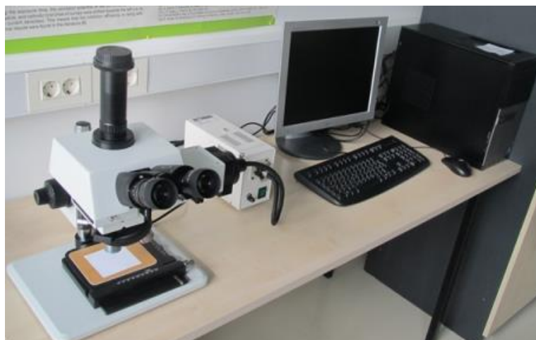
Slika 19. Optički mikroskop MXFMS-BD, Ningbo Sunny Instruments co.
