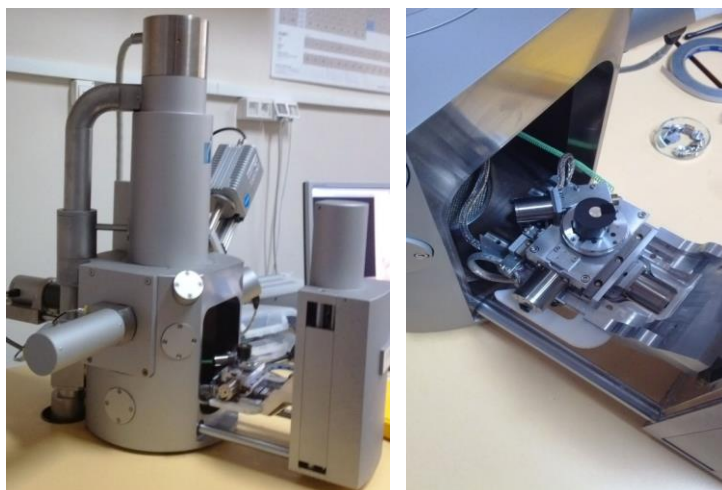
Slika 20. Pretražni elektronski mikroskop Tescan Vega TS5136LS
