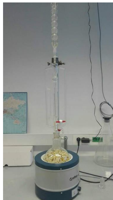
Slika 18. Aparatura za hidrodestilaciju aparat po Clevengeru
