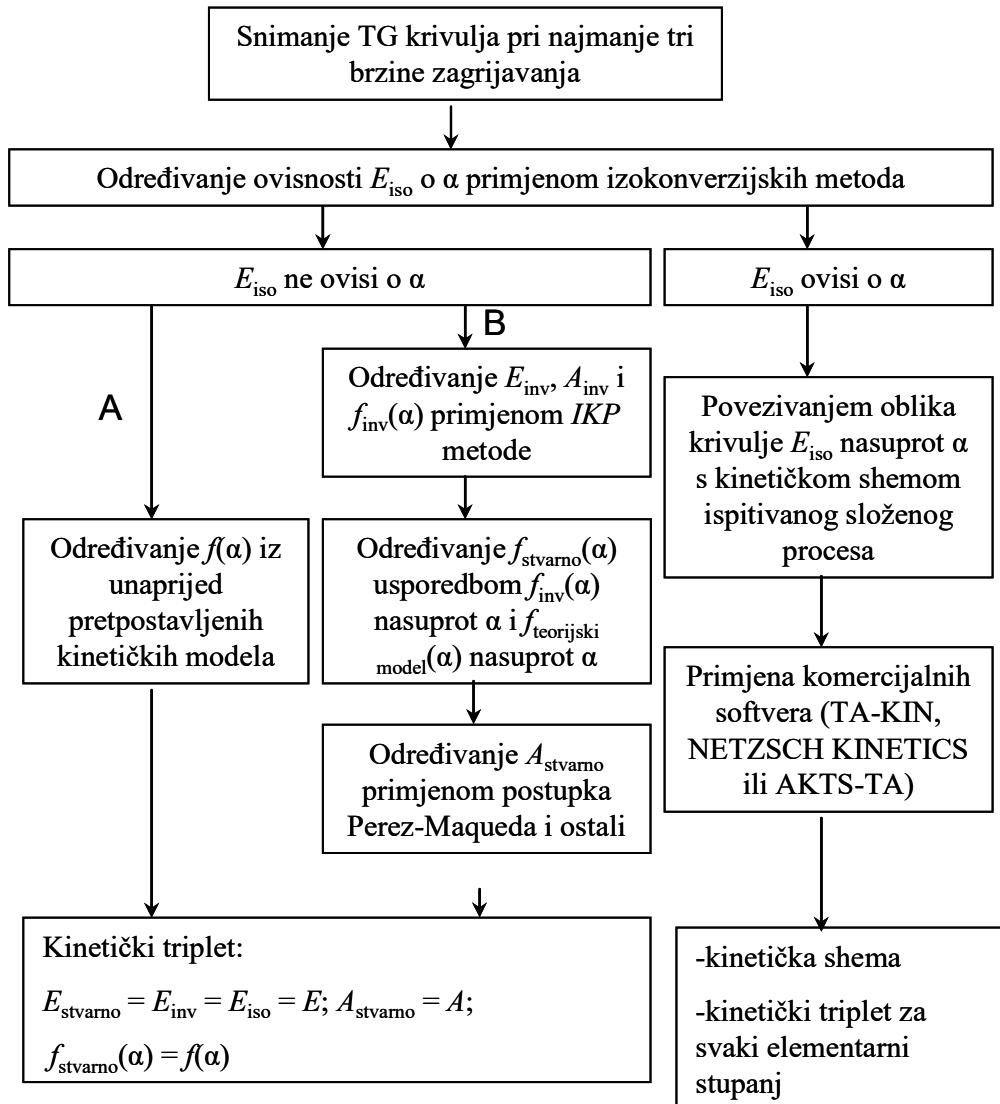
Slika 9. Opći algoritam za određivanje kinetičkih parametara iz dinamičkih TG podataka<sup>24</sup>
