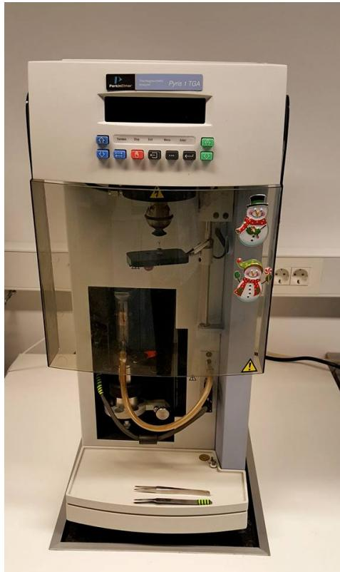
Slika 10.Termogravimetar Pyris 1 TGA
