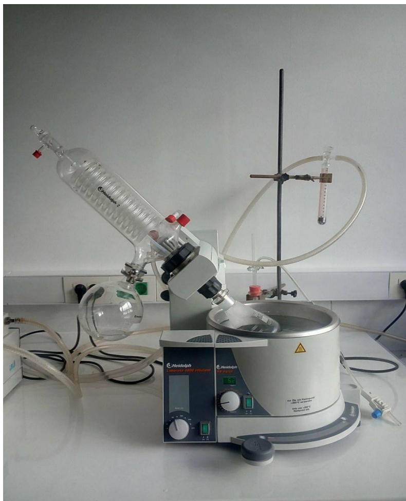
Slika 3. Rotacijski vakuum uparivač koji služi za potpuno uklanjanje metanola
