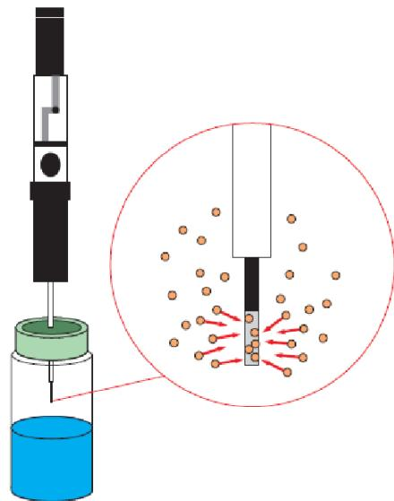
Slika 20. Princip ekstrakcije HS-SPME tehnikom<sup>16</sup>
