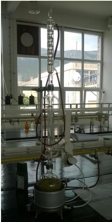
Slika 10. Aparatura za vodenu destilaciju po Clevengeru: 1- tikvica s okruglim dnom, 2- vodeno hladilo po Allihnu, 3- središnji dio aparature, 4- kalota, 5- otpornik promjenjivog otpora (reostat)
