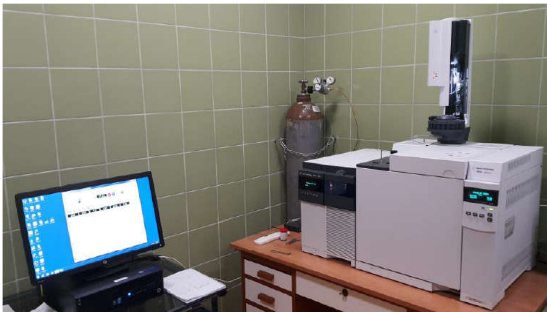
Slika 14. Vezani sustav plinska kromatografija-masena spektrometrija (GC-MS)
