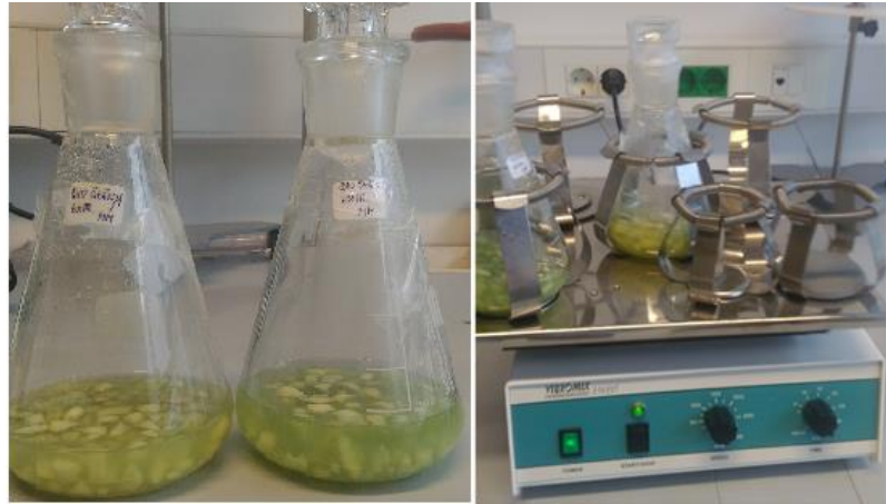
Slika 2.8. Ekstrakcija potpomognuta miješanjem na tresilici
