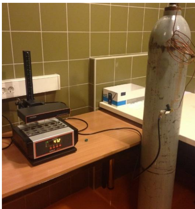
Slika 2.4. Aparatura za uparavanje u struji dušika
