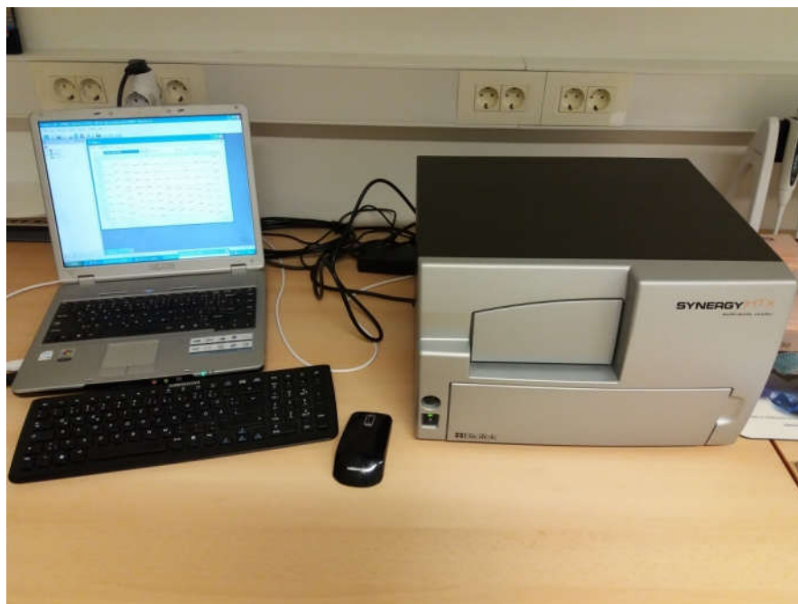
Slika 9. Spektrofotometar Synergy HTX S1LFA, BioTek, Winooski, USA.
