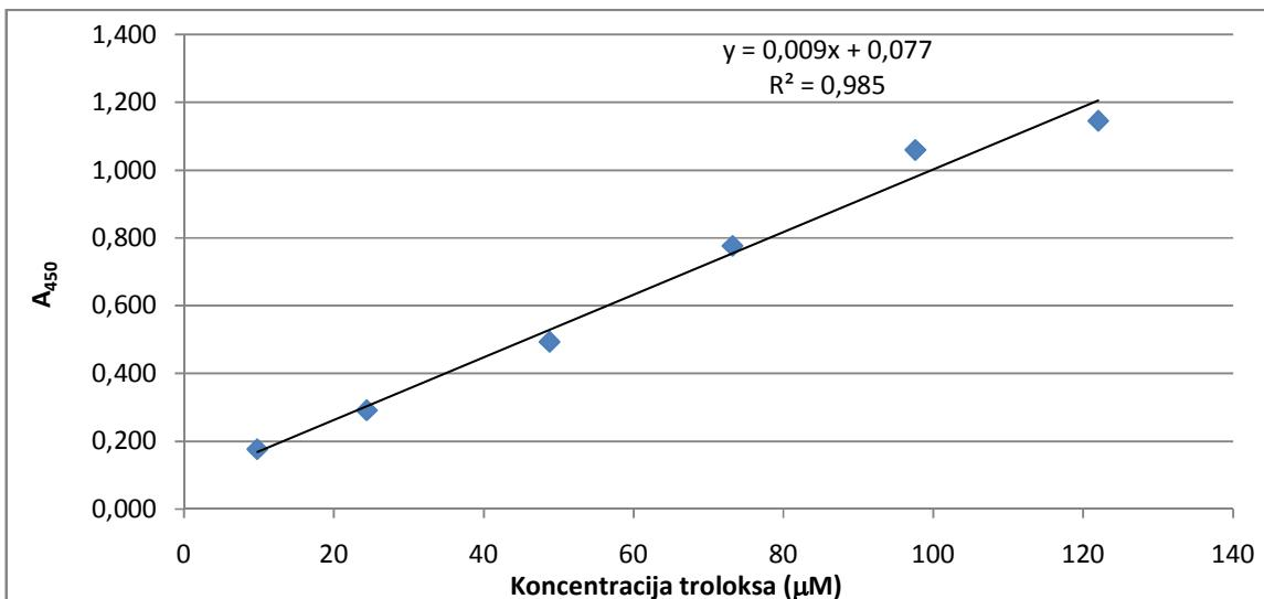
Slika 15. Umjerni pravac troloksa nakon 60 minuta
