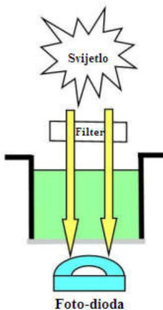
Slika 3. Pojednostavljena detekcija apsorbancije.<sup>8</sup>
