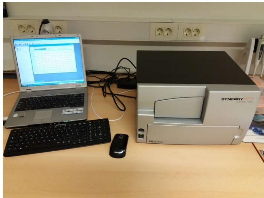
Slika 9. Spektrofotometar Synergy HTX S1LFA, BioTek, Winooski, USA.
