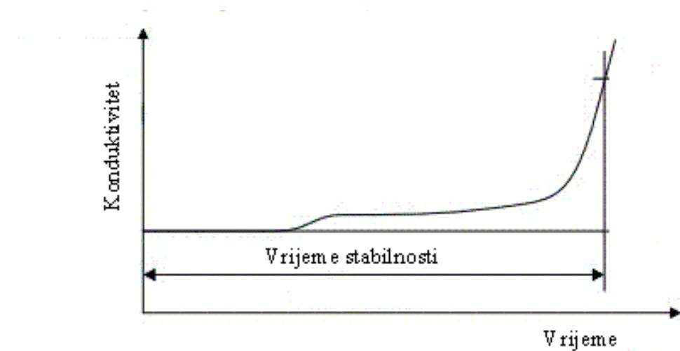
*Slika 5. Rancimat krivulja za određivanje vremena stabilnosti uzorka<sup>31</sup>*
