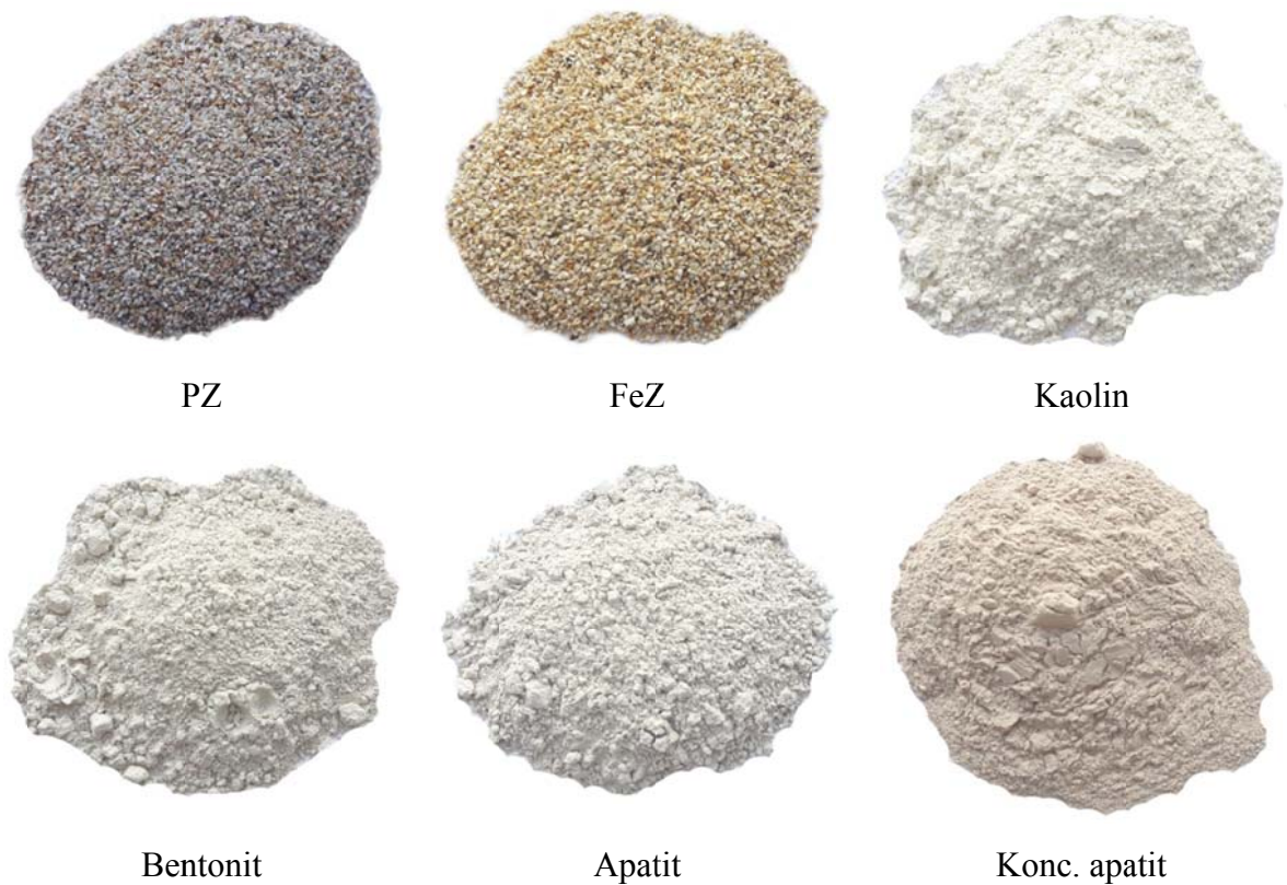
Slika 2.1. Uzorci korištenih sorbenata.
