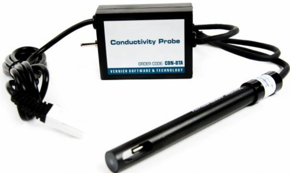
**Slika 10.** Osjetilo za mjerjenje provodnosti (1).
