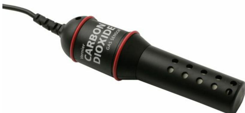
**Slika 5.** Vernierovo osjetilo za mjerjenje plinovitog CO<sub>2</sub> (*I*).
