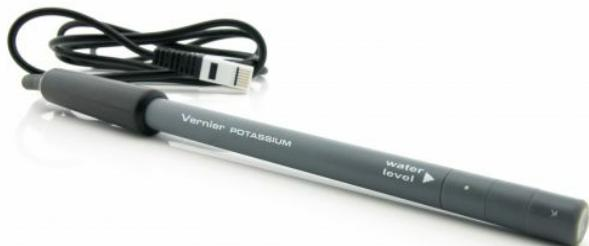
d) kalijeva ion-selektivna elektroda
