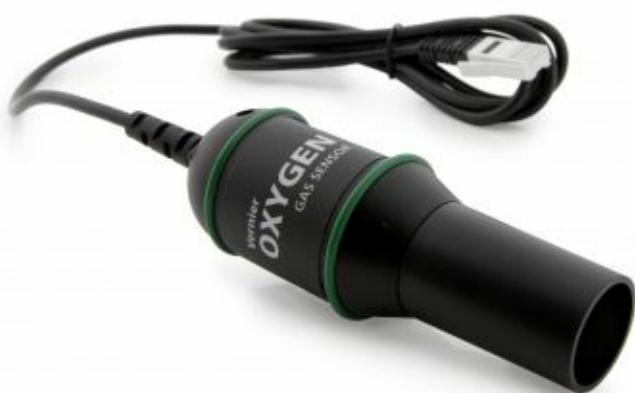
**Slika 4.** Vernierovo osjetilo za mjerjenje plinovitog O<sub>2</sub> (*I*).
