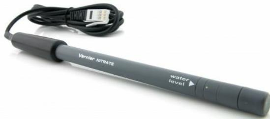
a) nitratna ion-selektivna elektroda
