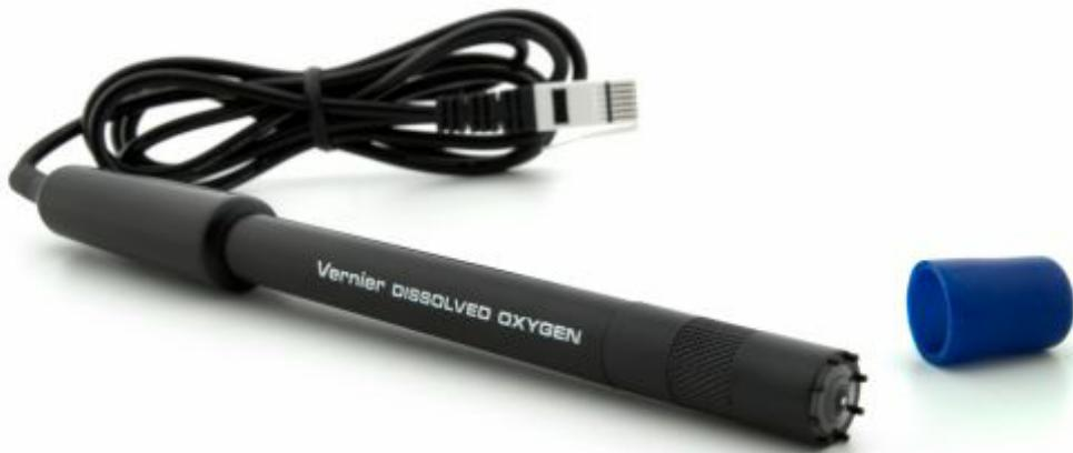
**Slika 7.** Vernierovo mjerno osjetilo za određivanje otopljenog kisika (7).
