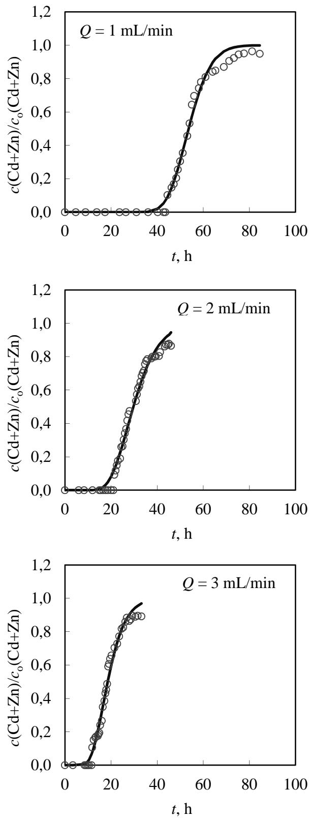
Slika 3.4. Usporedba eksperimentalnih rezultata i modelnih krivulja probaja prema ADR modelu pri tri različita protoka (Cd+Zn) otopine.
