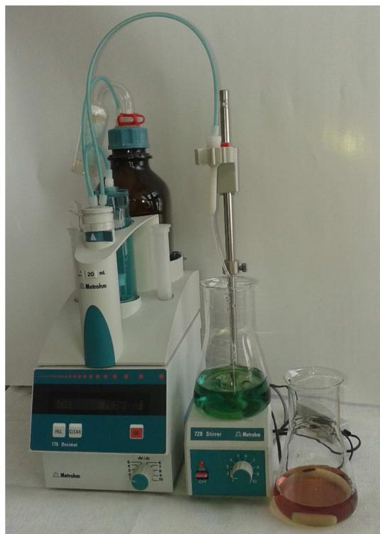
Slika 2.2. Titrator *Metrohm 775 Dosimat*.<sup>4</sup>
