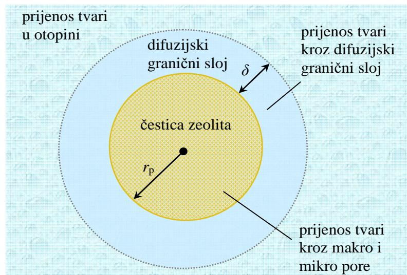
Slika 1.8. Stupnjevi prijenosa tvari u sustavu zeolit-vodena otopina;  $\delta$  - debljina difuzijskog graničnog sloja,  $r_p$  - polumjer čestice zeolita.<sup>12</sup>
