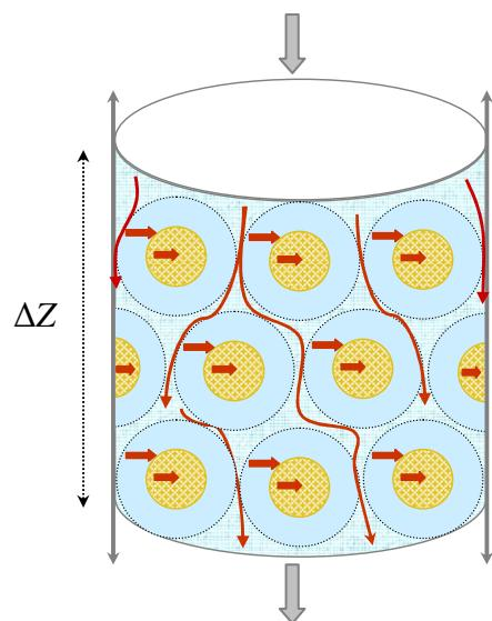
Slika 1.9. Mehanizmi prijenosa tvari postupkom u koloni.<sup>12</sup>
