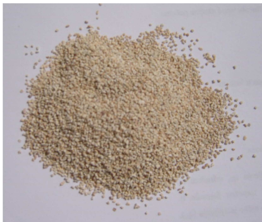
Slika 2.1. Uzorak zeolita klinoptilolita veličine čestica 0,6 - 0,8 mm. 4
