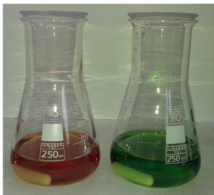
Slika 2.3. Promjena boje pri kompleksometrijskom određivanju ukupne koncentracije kadmijevih i cinkovih iona. 4
