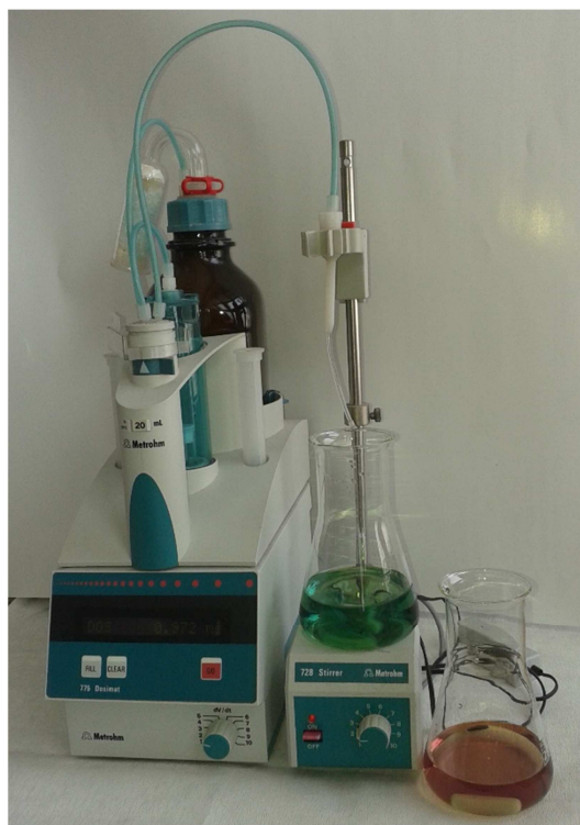
Slika 2.2. Titrator Metrohm 775 Dosimat . 4
