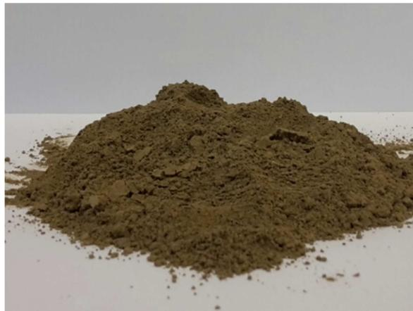
Slika 2.2. Pripremljeni uzorak tlaveličine čestica 0,075 mm
