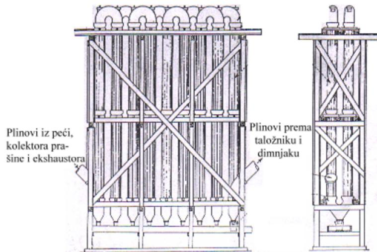
Slika 1.4.Čermakovi keramički kondenzatori za živu<sup>8</sup>
