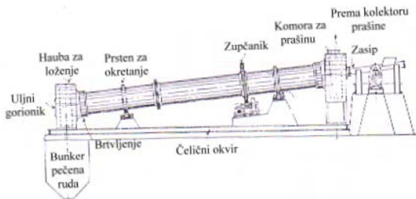
Slika 1.7. Rotacijska peć za dobivanje žive<sup>8</sup>
