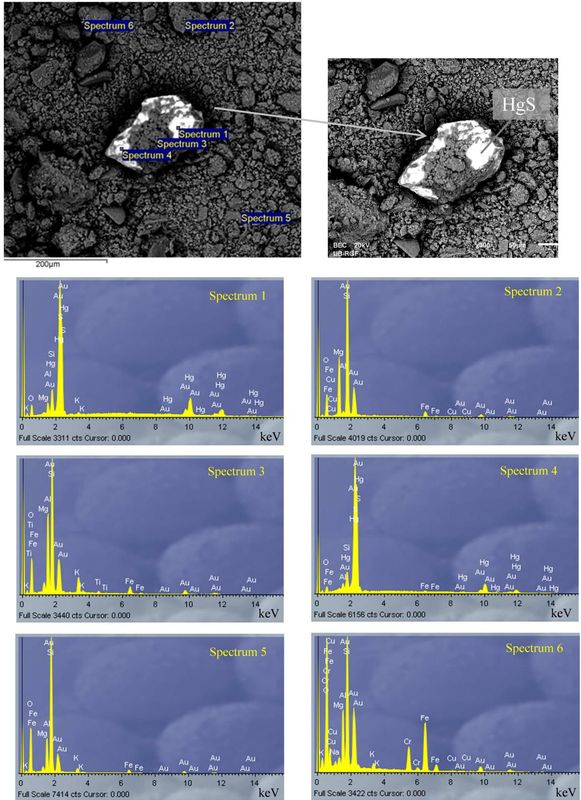
Slika 2.3. SEM snimka čestica tla onečišćenog živom i pripadajući EDS spektri
